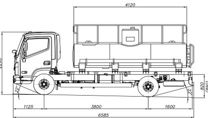
Водовоз для технической воды 4м3 без насоса
