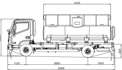
Водовоз для технической воды 4м3 с насосом
