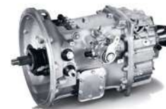
M035S5 (для EX6 и EX8): 5-ступенчатая механическая коробка передач
